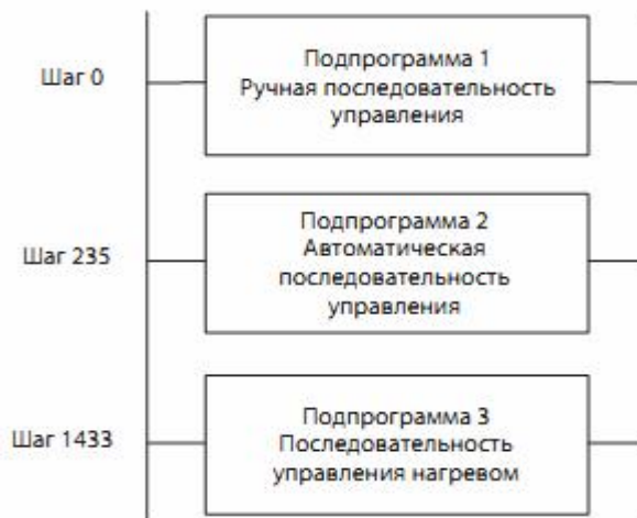
Рис. 2-4. Типичная последовательность событий в программе ПЛК
